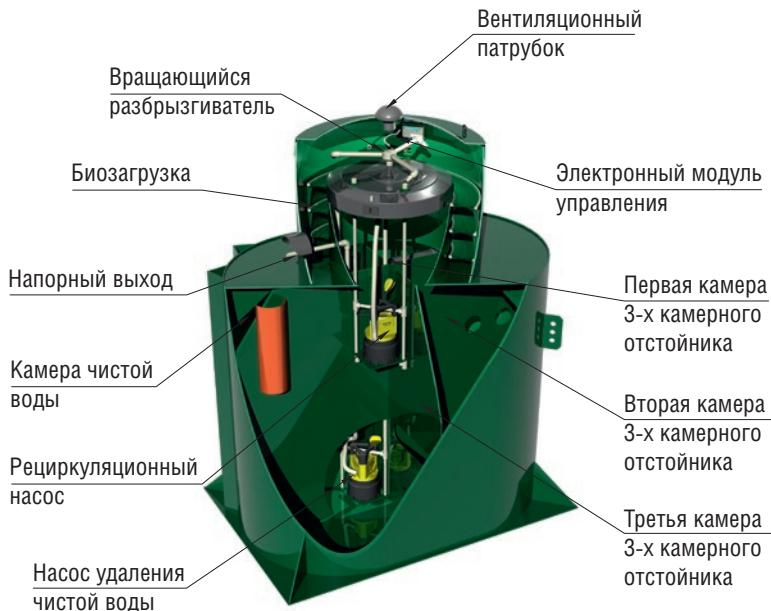
Рисунок 2. Схема Станции Alta Bio со встроенным колодцем для сбора очищенной воды и напорным выбросом
