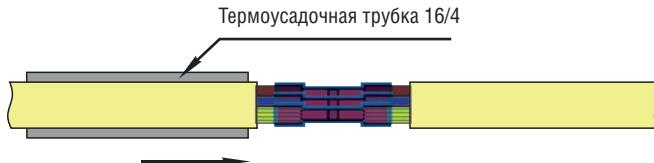
**7.** убедиться, что термоусадочная трубка перекрывает внешнюю изоляцию соединяемых кабелей не менее, чем на 10 мм;
