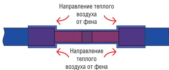
4.4. провести визуальный контроль качества соединения, в том числе на предмет отсутствия температурных повреждений изоляции кабеля;
