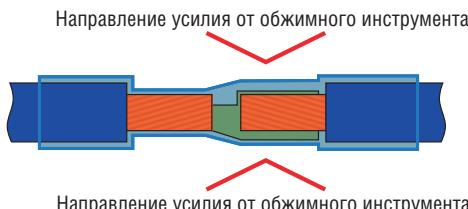
4.3. с помощью электромонтажного фена, прогреть соединитель до полной термоусадки, направление прогрева – от центра соединителя к краям;
