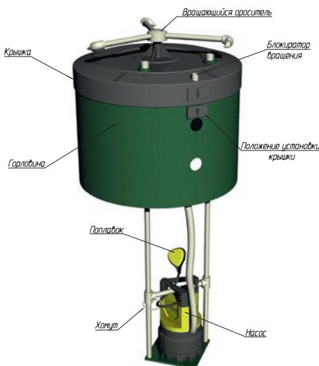
Рисунок 17. Установка циркуляционного насоса Станции
