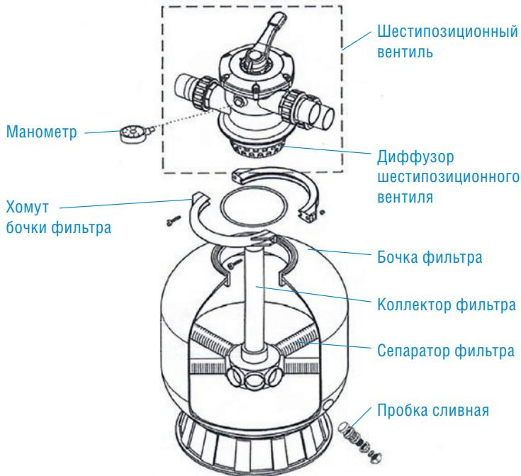
*Рисунок 19. Устройство напорного сорбционного фильтра*
