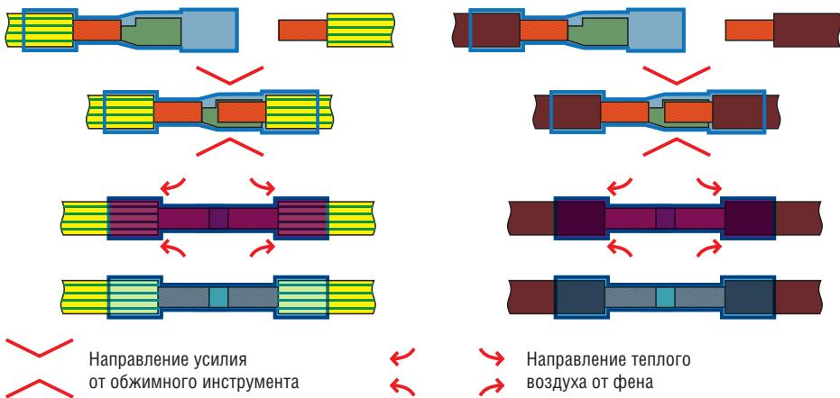
**6.** установить термоусадочную трубку 16/4 поверх соединителей и защищенных участков кабелей;
