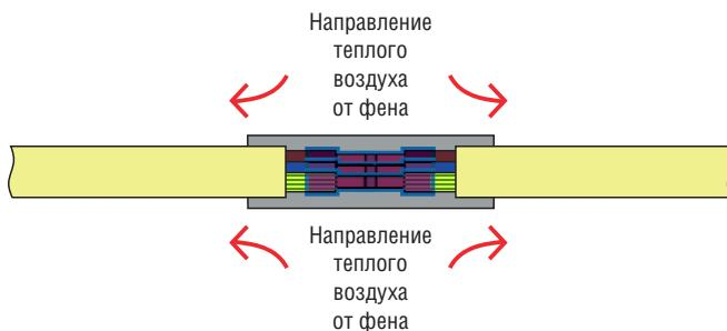
**9.** произвести визуальный контроль полученного соединения, в том числе на предмет отсутствия температурных повреждений внешней изоляции кабеля.
