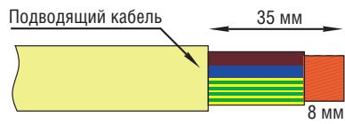
Присоединяемая жила Станции с установленным соединителем Scotchlok
