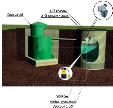
Колодец поглощения может быть выполнен из бетонных колец или при помощи пластикового колодца с перфорированным основанием и стенками.
