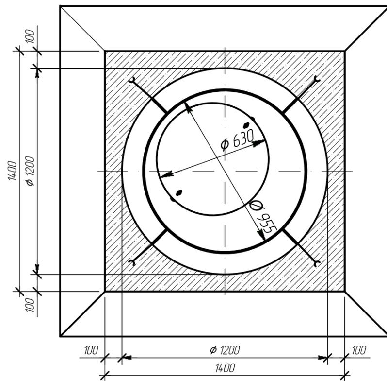
Крутизна откосов подбирается по таблице №1 в зависимости от глубины выемки и типа грунта
